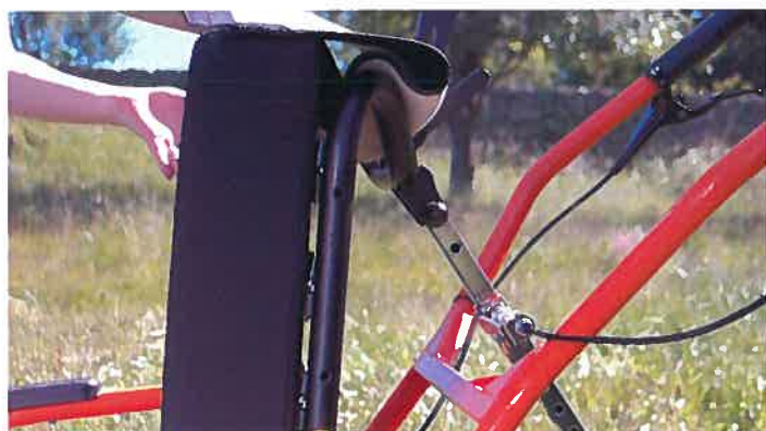
15- Positionner le coussin du dossier en passant la doublure en tissu derrière le dossier et le maintenir à l'aide du scratch.
