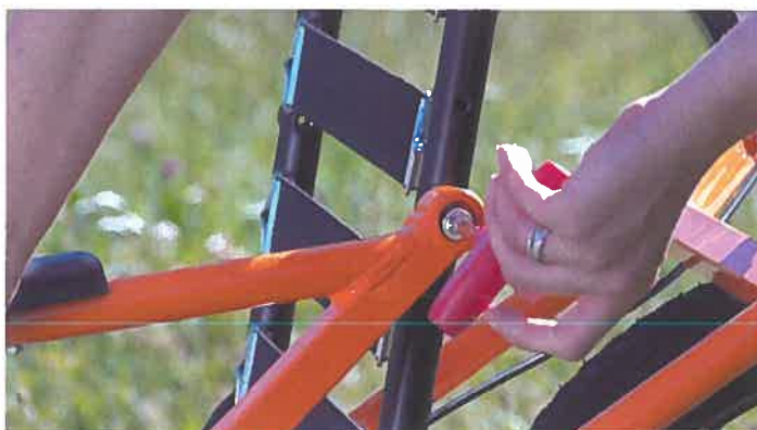
11- Engager la vis d'accouder sur le dossier avec la clé fournie
