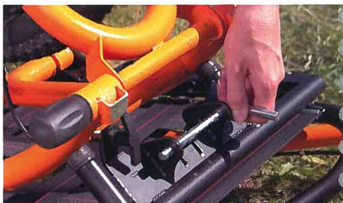
4- Enlever la goupille de sécurité et retirer l'axe de son logement
