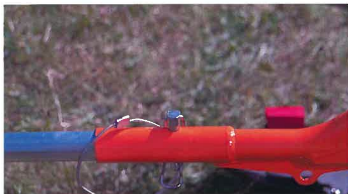
17- Verrouiller les bras avec la goupille de sécurité
