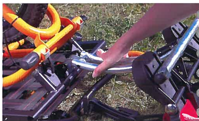
6- Positionner le pied dans les encoches tout en serrant les deux tubes afin de faciliter son insertion
