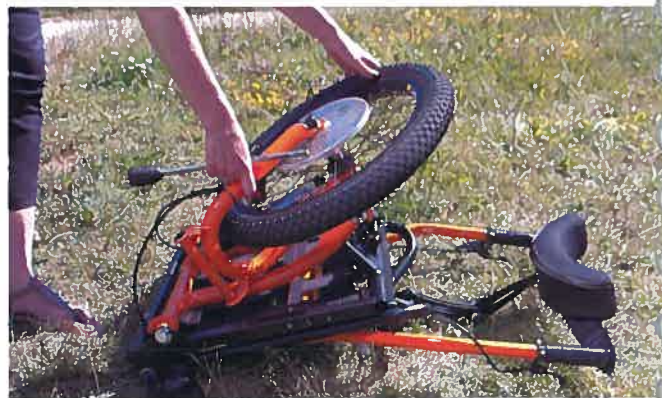
2- Retirer la broche et la goupille de leur emplacement et faire pivoter la roue
